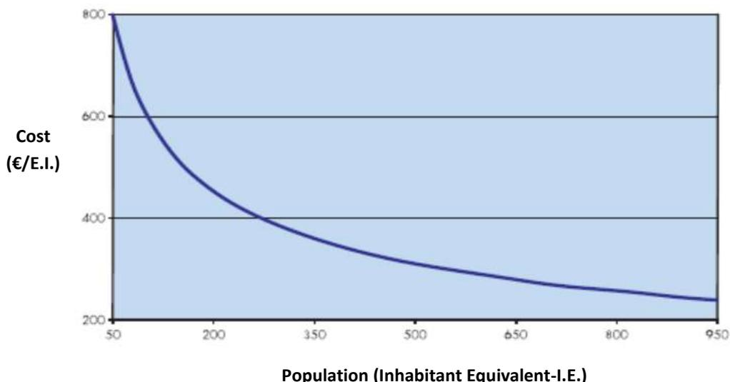
Figure 3-59: Lagooning implementation costs depending on the equivalent population. Source: Manual para la implantación de sistemas de depuración en pequeñas poblaciones (MARM).
