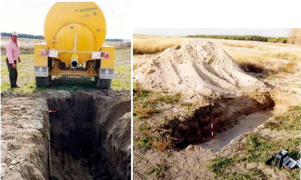
Figuras 2-23 a) y b). Ensayos de infiltración en balsas “provisionales” en Santiuste. Octubre de 2000.
