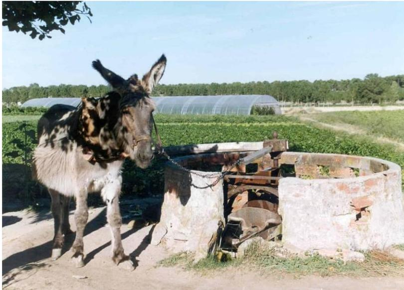
Figura 2-6. El alumbramiento de aguas mediante norias y acémilas fue una pauta habitual en la *Cubeta* durante el desarrollo agrícola de los siglos XIX y XX, hasta la implantación de la bomba con motor de explosión. (Fotografía por cortesía de D. Luis Galán, IGME).
