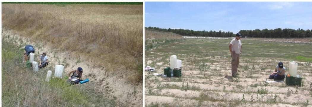
Figuras 11-6 a) y b). Ensayos de infiltración en los tramos experimentales de canal donde fueron instalados geotextiles en el fondo siete meses antes (a) y en la zona del fondo de la balsa con caballones (b). Fotos: 15/10/2009.
