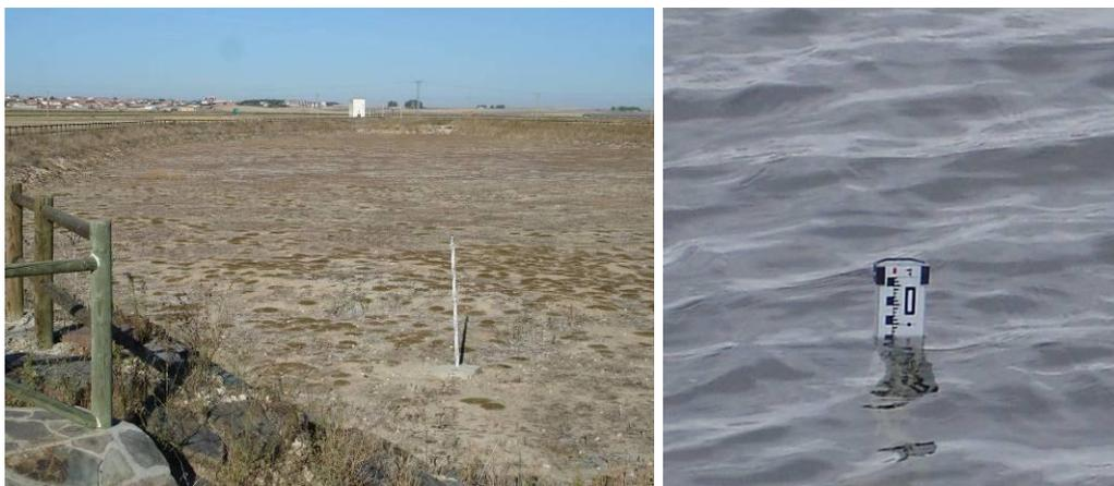
Figuras 11-1 a) y b) .Baliza sobre dado de hormigón en la balsa de infiltración-decantación para controlar la altura de la lámina de agua, como criterio para decidir la altura de los dispositivos de parada a la salida de la balsa hacia los canales. Fotos tomadas el 15/10/2009 y el 04/03/2010, respectivamente.
