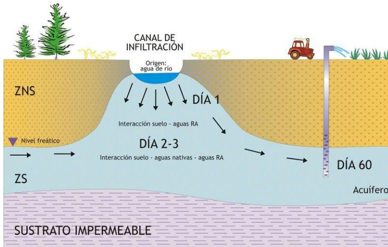
Figura 3-2. Esquema de un sistema MAR operativo con carácter didáctico elaborado durante el desarrollo del proyecto de I+D+i DINA-MAR y cargado en la Wikipedia. [http://es.wikipedia.org/wiki/Recarga\\_artificial\\_de\\_acu%C3%ADferos](http://es.wikipedia.org/wiki/Recarga_artificial_de_acu%C3%ADferos)
