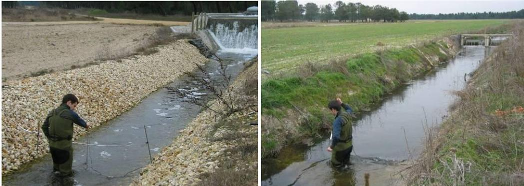
Figuras 5-3 a) y b). Fotografías de aforo secuencial en el canal de recarga artificial, Estación 1 (cabecera) y 4, (Pradillos del Barco). Fotos: 21/01/2004.
