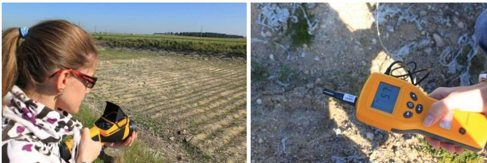
Figuras 11-10 a) y b). Mediciones de termografía en balsa de recarga gestionada y verificación de las medidas mediante termómetro de suelos. Fotos: 20/05/2010.
