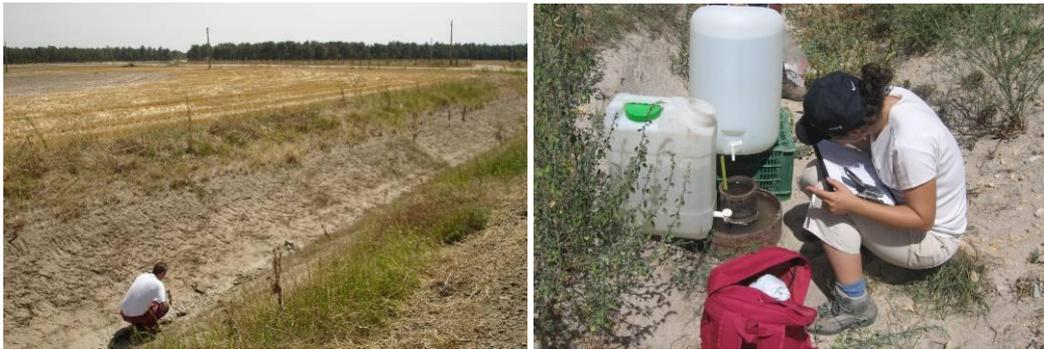
Figuras 8-10 a) y b). Ensayo de infiltración con infiltrómetro de doble anillo. Fotos: 12/07/2007.
