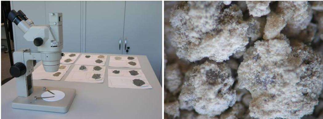
Figuras 8-8 a) y b). Estudio y procesado de las muestras de colmatación muestreadas en las estaciones de control. La caracterización y estudio de la distribución de los distintos procesos se presenta en la cartografía 13-5.
