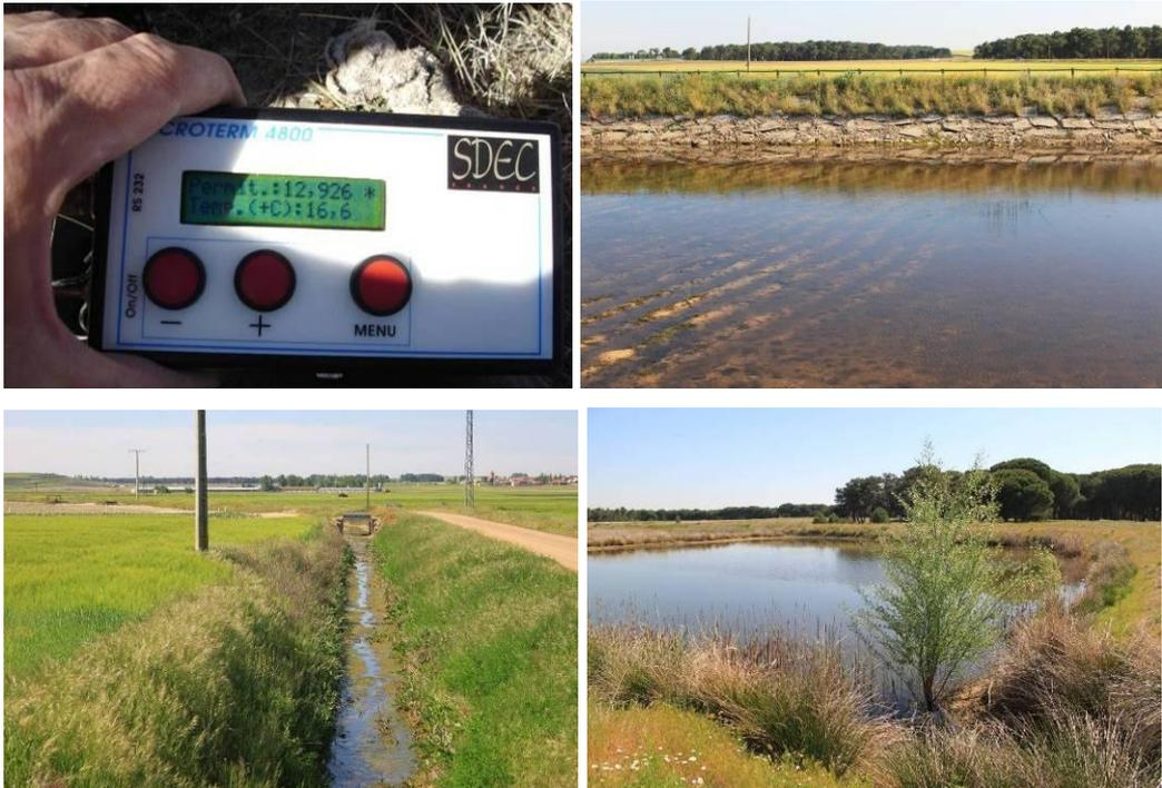
Figuras 13-2 a) a d). Medidas in situ mediante *Microterm* en las estaciones DINA-MAR ZNS (a); procesos colmatantes en el fondo de la balsa con caballones situada en cabecera (b); desarrollo de lemnáceas en determinados sectores del canal (c) y seguimiento de los humedales artificiales del Sanchón (d). Fotos: 11/05/2011.
