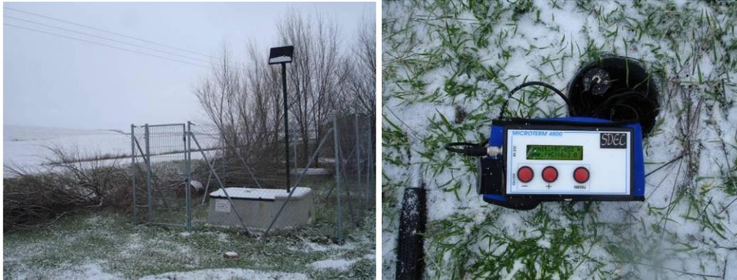
Figuras 11-3 a) y b). Estación DINA-MAR ZNS-2 (a) y lectura directa de los sensores con *Microterm* (b). Los sensores funcionaron correctamente en estas condiciones. Fotografías tomadas el 16/12/2009.
