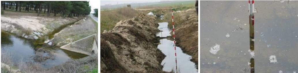
Figuras 6-8 a) a c). Ramal del canal Este especialmente acondicionado para la ejecución seriada de ensayos de infiltración a lo largo de un ciclo de recarga. Fotos: 07/10/2004 (a) y 23/01/2005 (b y c).
