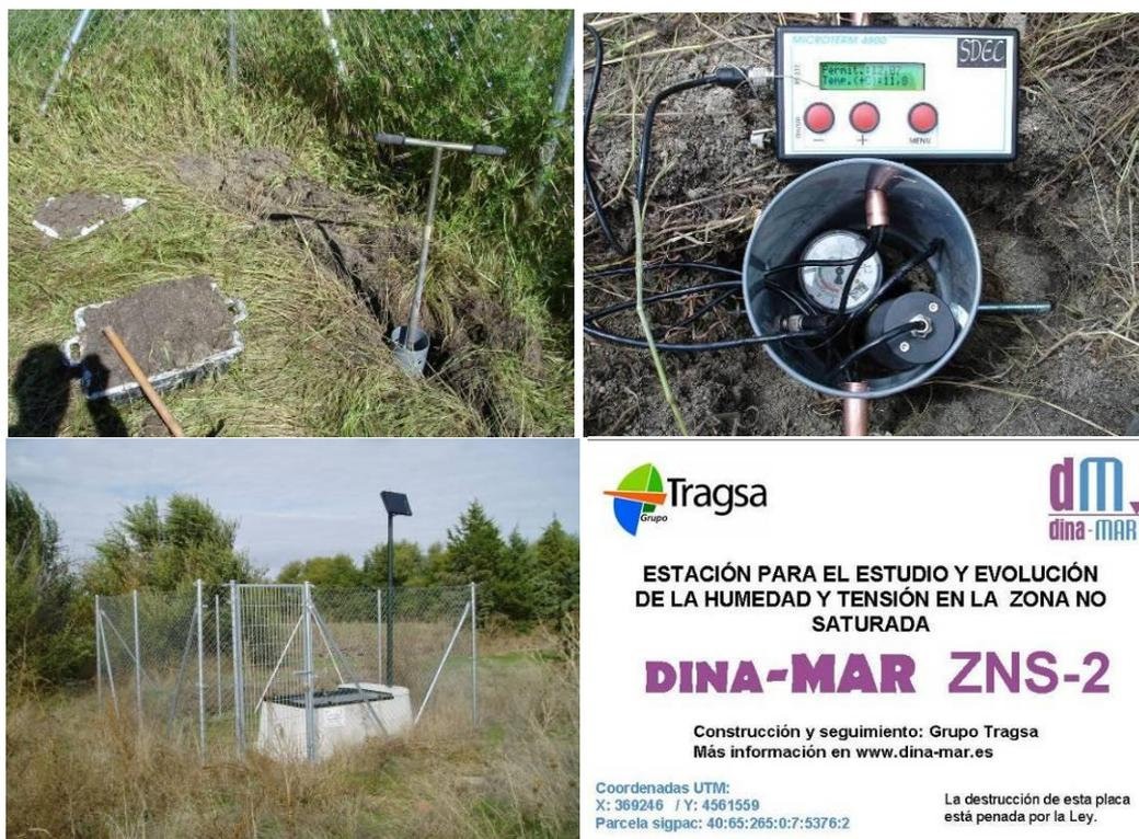
Figuras 9-18 a) a d). Momentos de la instalación de los sensores, aspecto final y placa identificativa de la estación DINA-MAR ZNS 2 en Villagonzalo de Coca (Segovia). Fotos: 07/06/2008.
