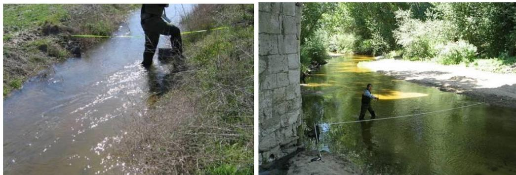
Figuras 7-8 a) y b). Fotografías de aforos secuenciales en el canal de recarga y en los cauces fluviales relacionados. Campaña de marzo de 2006.
