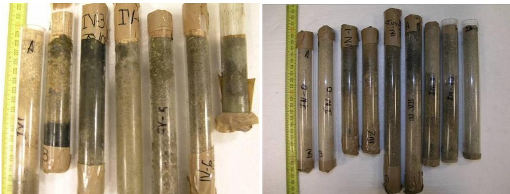
Figuras 13-3 a) y b). Perfiles de colmatación en probetas.
