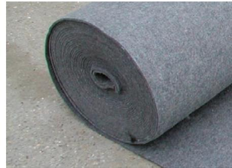
Figura 131. Manta retenedora de agua.
