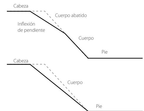
Figura 227. Esquema de abatimiento de la pendiente en la cabeza y el abatimiento de la cabeza.
