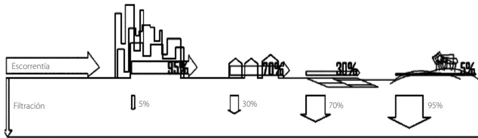
Figura 5. Incremento de escorrentía superficial según impermeabilización superficial.
