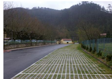
Figura 90. Aparcamiento con pavimento permeable.
