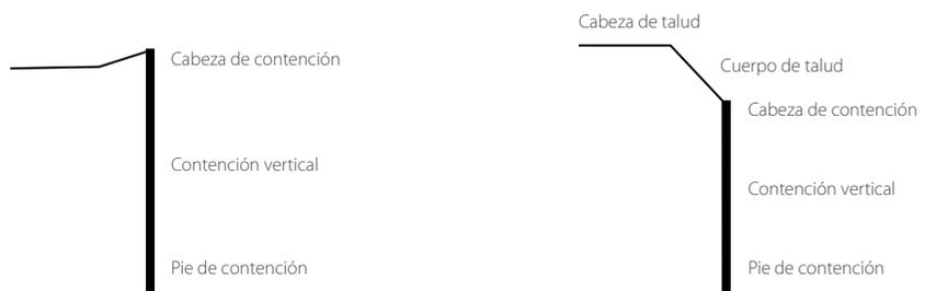
Figura 224. Comparativa de los sistemas de contención vertical completa y combinada del terreno.
