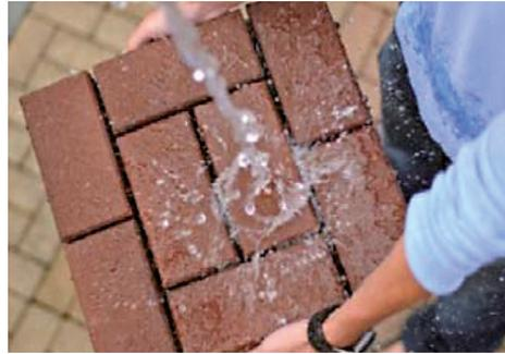
Figura 86. Ejemplo de pavimento permeable.
