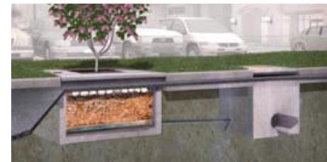
Figura 98. Alcorque conectado a la red.
