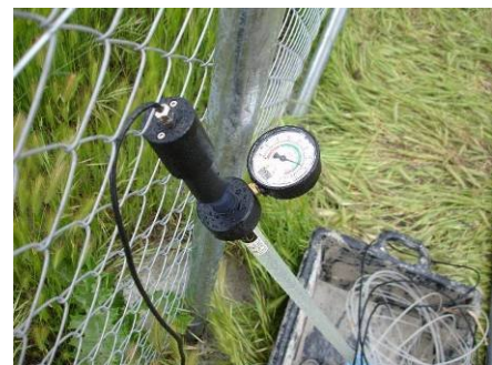
Figuras 4 a) a d)- Instrumentación instalada en las estaciones DINA-MAR ZNS (tensiómetros y humidímetros).
