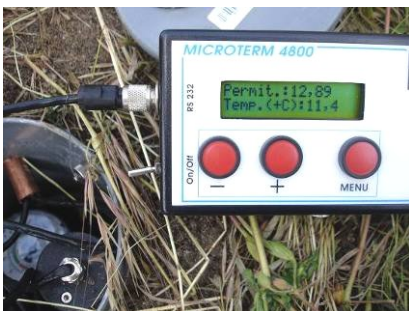
Figuras 4 a) a d)- Instrumentación instalada en las estaciones DINA-MAR ZNS (tensiómetros y humidímetros).
