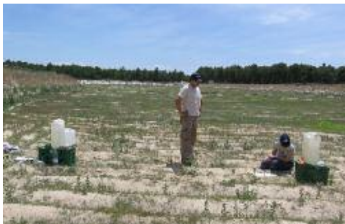
Figura 12. Ensayos de infiltración mediante infiltrómetro de doble anillo en la superficie convexa y cóncava de los caballones labrados en el fondo de la balsa de decantación y AR que hay en la cabecera del dispositivo de Santiuste.
