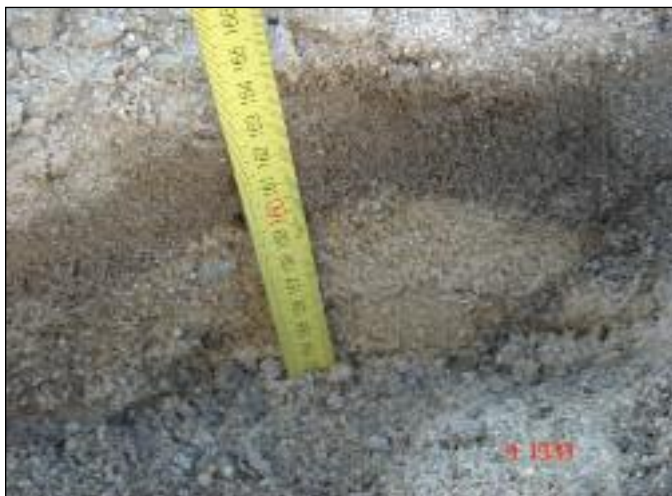
Figura 3. Procesos colmatantes bajo el fondo del canal de recarga artificial (perfil del suelo).
